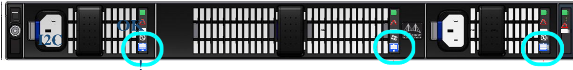
Şekil 3: Hava Akış Yönü İşaretleme - Konnektör Yan Çıkışına Güç Yan Girişi
