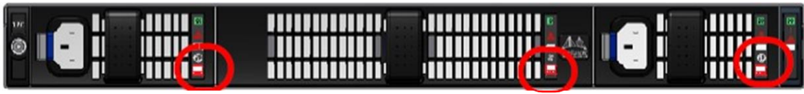
Şekil 2: Hava Akış Yönü İşaretleme - Güç Yan Çıkışına Konnektör Yan Girişi
