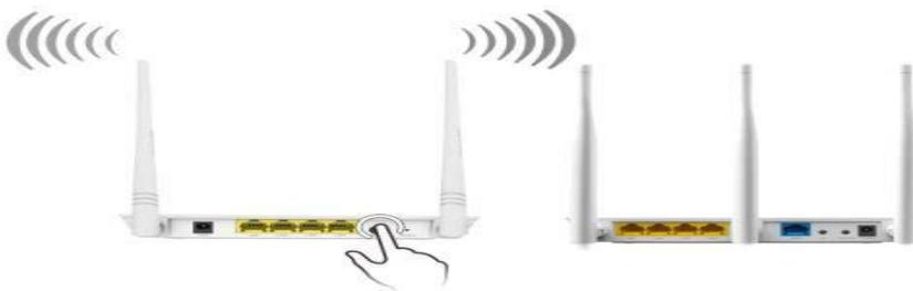
3. Kablosuz Menzil Arttırıcı üzerindeki Range Extender LED'i sürekli yandığında, router ile bağlantı sağlanmıştır.
