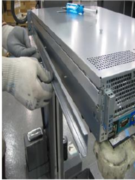
Şekil 4: Veri Depolama birimi ISILON kızak bağlantıları
