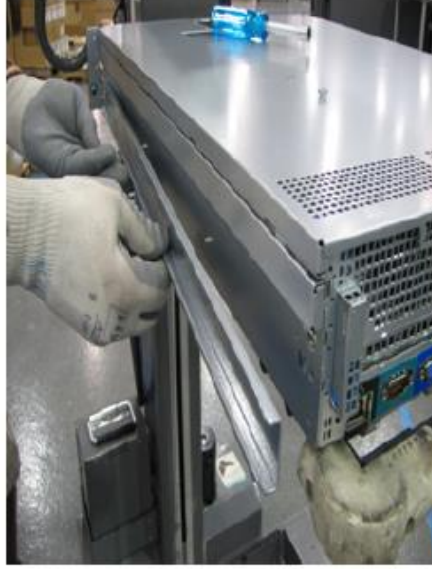
Şekil 4: Veri Depolama birimi VPLEX kızak bağlantıları
