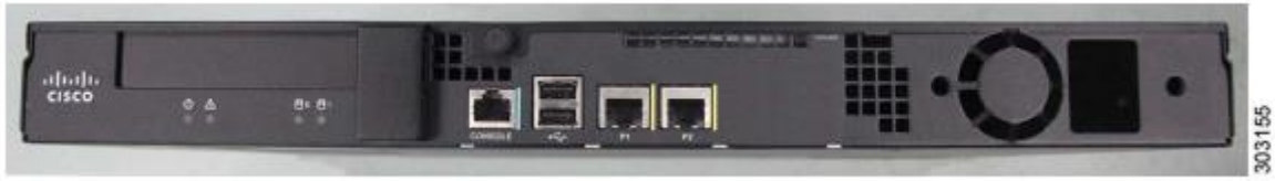
Şekil 1-9 Cisco C170 ve Cisco M170 için Arka Panel Bağlantı Noktaları
