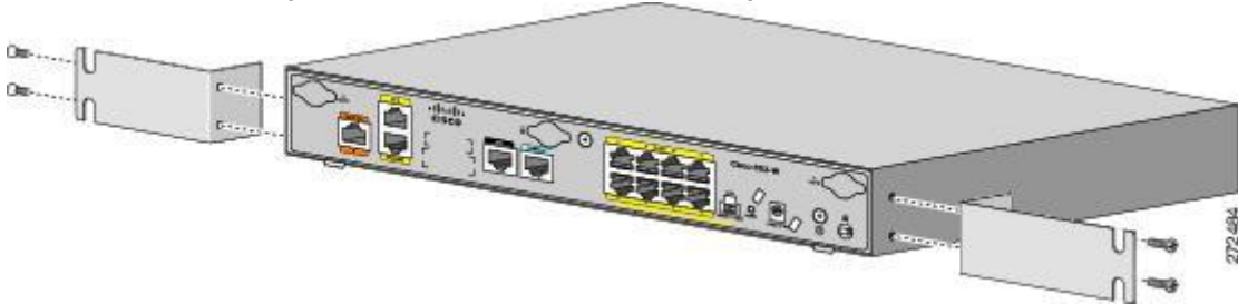
Şekil 2-49 Raf Montaj Braketlerini Cisco 890 Series ISR'ye Takma
