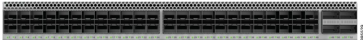
Şekil 13. C9500-48Y4C için Yerel Bağlantı Noktası Numaralandırma
