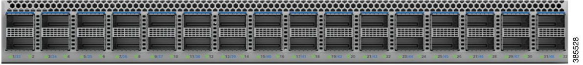
Şekil 11. C9500-32QC için Yerel Bağlantı Noktası Numaralandırma
