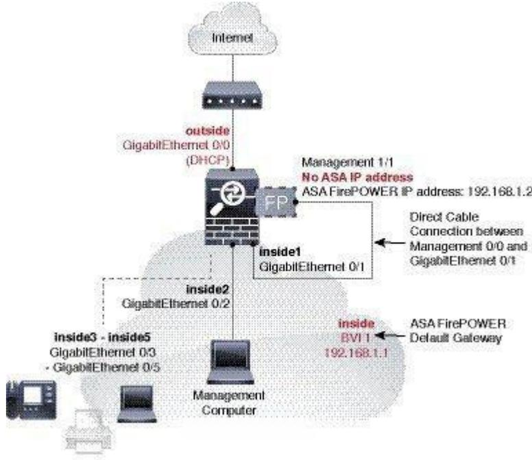
**Not:** ASA 5525-X, 5545-X ve 5555-X, GigabitEthernet 0/ 0'dan GigabitEthernet 0/ 7'e kadar olan arayüzleri içerir .
