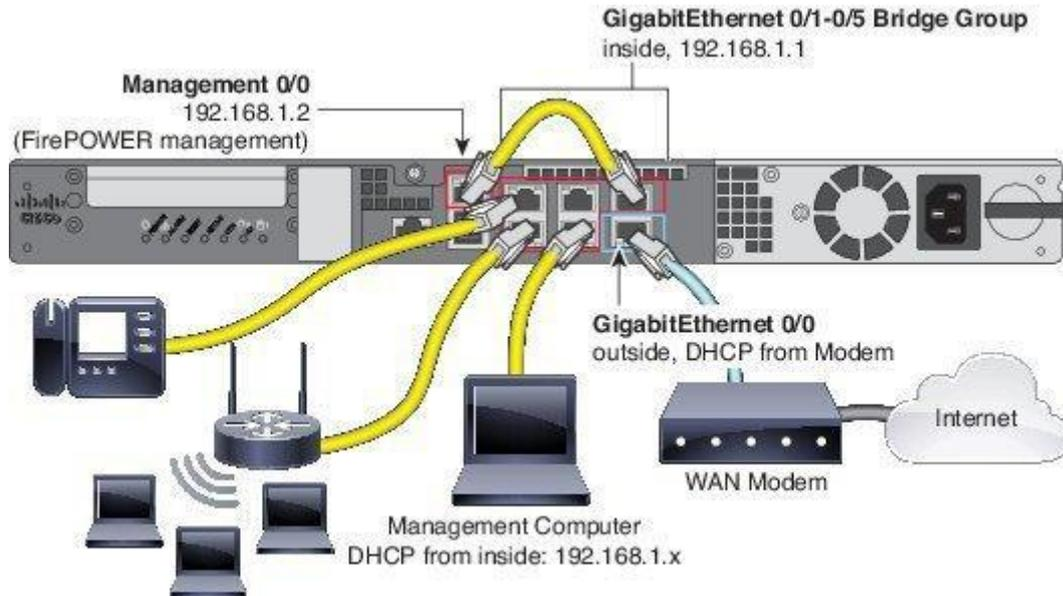
a. Kablo Yönetimi 0/0 (ASA FirePOWER modülü için) doğrudan GigabitEthernet 0/1'den GigabitEthernet 0/5'e (ASA 5525-X, 5545-X ve 5555-X için 0/7) kadar birine bağlayın.
